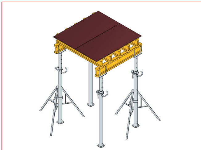
Zastosowanie trójnogu - schemat
