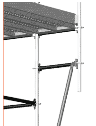
Rys. 3.29 – Rozszerzenie za pomocą rygli i stężeń
