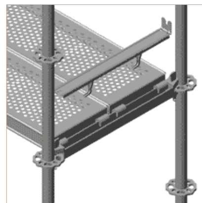
Rys. 3.19 – Etap 2 – Nałożyć zabezpieczenie
