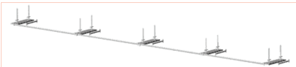
Rys. 3.52 – Etap 1 – Montaż podstawek
