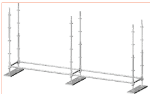
Rys. 3.56 – Przykład użycia jednej długości stojaków
