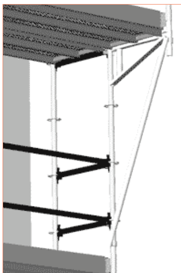
Rys. 3.28 – Rozszerzenie za pomocą wspornika 0,73 m i stężenia
