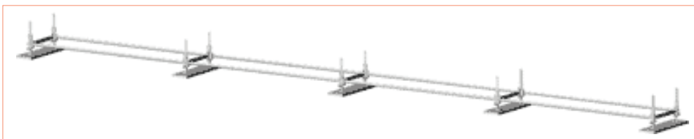
Rys. 3.54 – Etap 3 – Spinanie elementów początkowych
