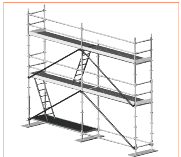
Rys. 3.23 – Przykład rusztowania z zabezpieczeniem bocznym
