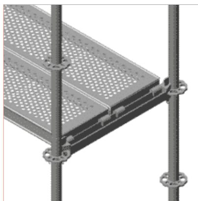
Rys. 3.18 – Etap 1 – Położyć pomosty
