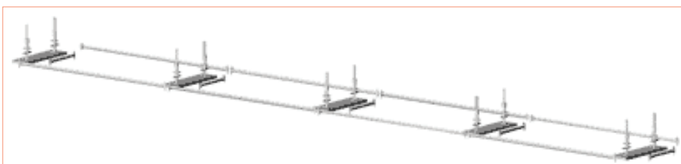
Rys. 3.53 – Etap 2 – Nałożenie elementów początkowych
