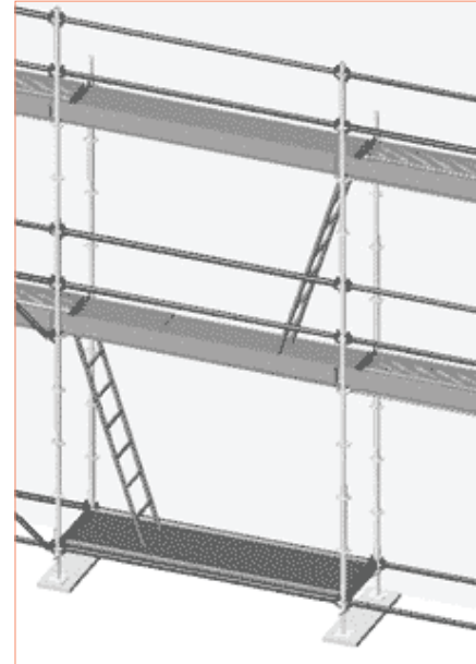
Rys. 3.41 – Wejście na rusztowanie z użyciem prześciowych pomostów aluminiowych wyposażonych w drabiny aluminiowe
